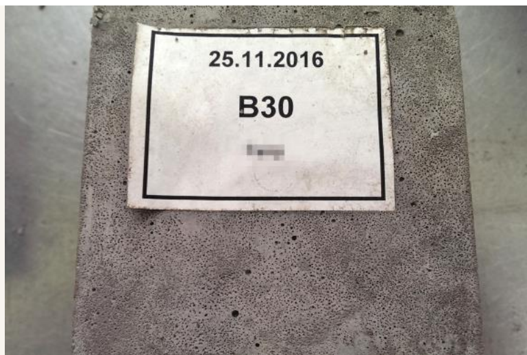
Пористая структура цементного камня у образца, приготовленного с помощью моющего средства
