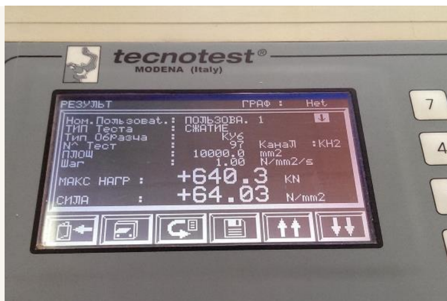
Результат испытаний образца бетона с добавкой SikaPlast 520N
