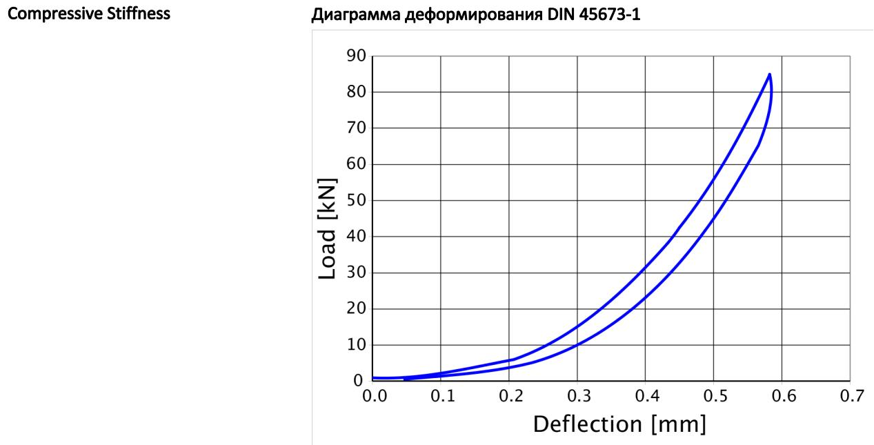
Жесткость при статической нагрузке по DIN 45673-1. Размеры тестовых образцов 360 × 160 × 25 мм;
