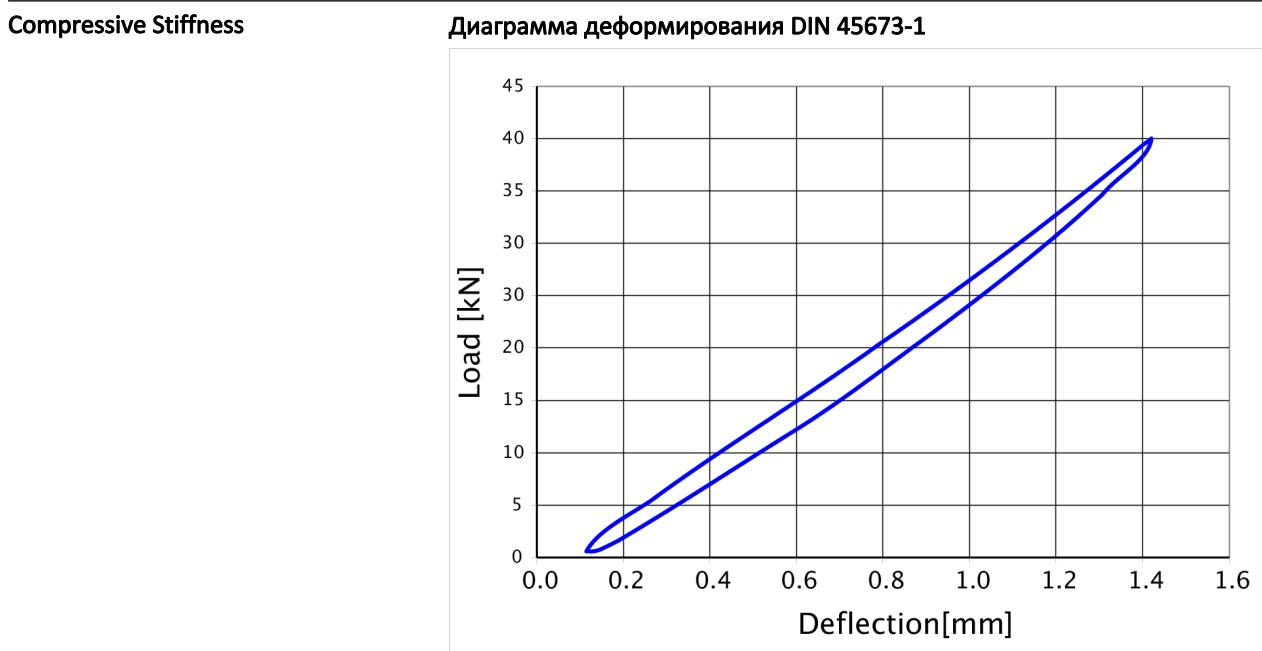
Аналог статической жесткости по DIN 45673-1. Размеры тестового образца 360 × 160 × 25 мм;
