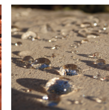
Вид поверхности после обработки гидрофобизирующим составом Sikagard®-703 W
