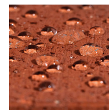
Вид поверхности после обработки гидрофобизирующим составом Sikagard®-703 W
