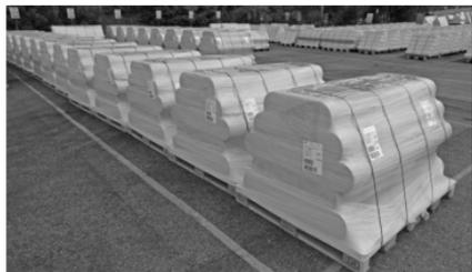
На строительной площадке мембраны Sikaplan® G должны храниться в прохладных и сухих условиях и должны быть защищены от любых погодных воздействий.
