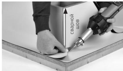
— Выполните предварительную и окончательную сварку вдоль вертикального шва, начиная от нижнего угла.
