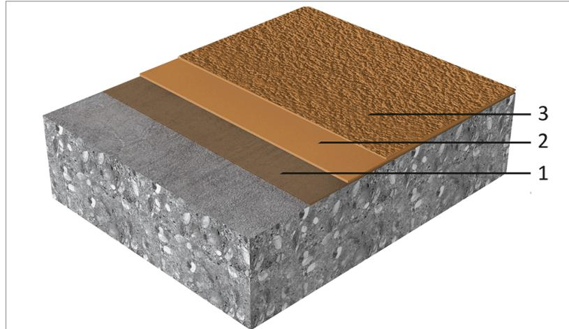
Sikafloor® Pronto RB-27 система (~ 3–5 мм)
