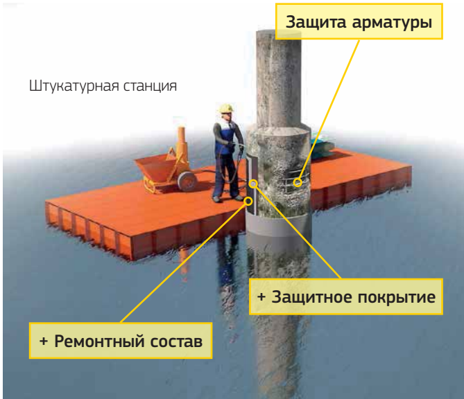
Ремонт надводной части
